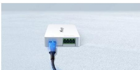
Der VO-UC100 kann direkt am gerät über die USB Typ C Schnittstelle konfiguriert werden und auhc aus der Ferne über LoRaWAN.
